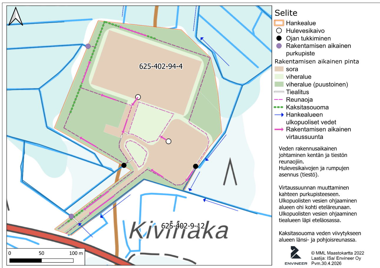
Kuva 14. Hankealueen hulevesien johtaminen rakentamisen aikana.
