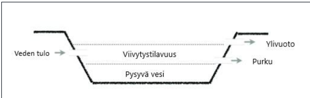
Kuva 12. Tasaussaltaan toimintaperiaate.
